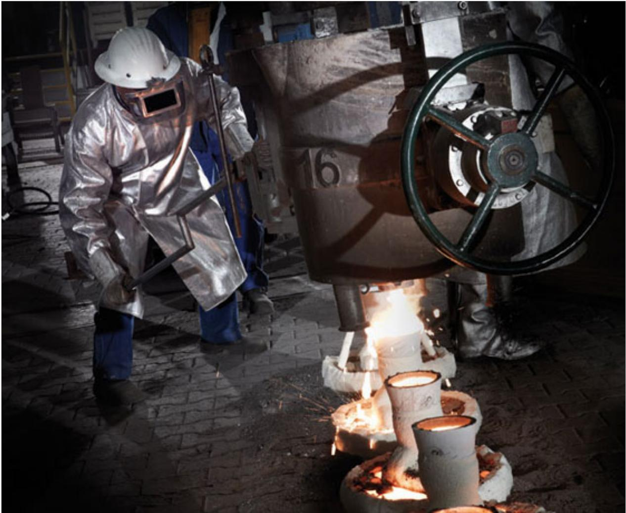
*Der flüssige Stahl wird auf Kommando in die Formen eingefüllt und nimmt die für ihn vorbestimmte Form an, Foto von Jan Hosan für pure cast*
