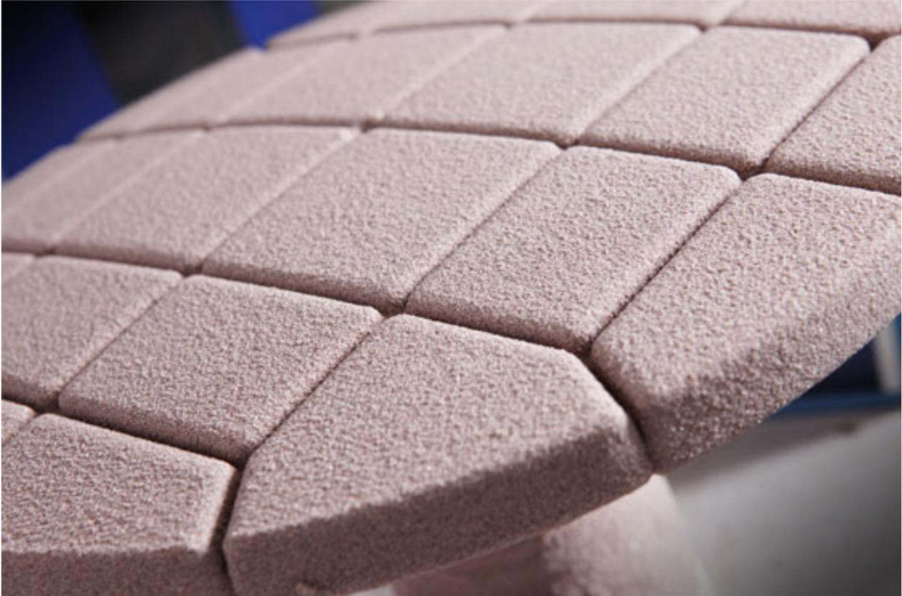
*Durch abwechselndes Tauchen in Keramikmasse und Besanden mit Feuerfeststoffen entsteht ein Keramikmantel um die Wachformen herum. Nach dem Schmelzen des Wachses wird die Form bei 1000° Celsius gebrannt / Fabian Baumann und Sönke Hoof von Formfjord*
