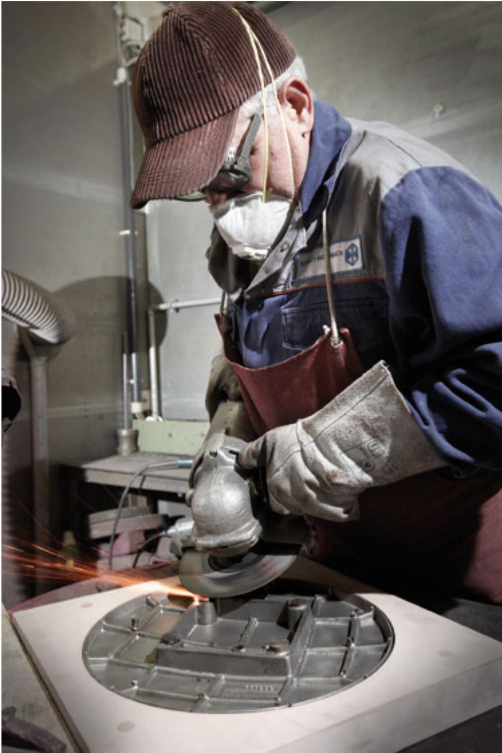
*Beim Erkalten brechen die Keramikhüllen und die frischen Gussunikate werden zum ersten Mal sichtbar, Foto von Jan Hosan für pure cast*
