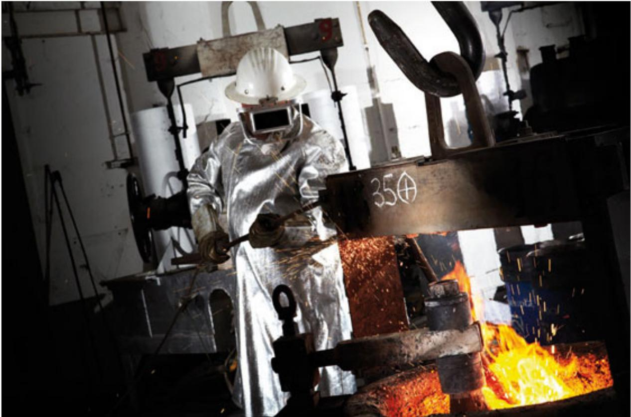
*Ist die richtige Gießtemperatur erreicht, wird der Ofen gekippt und der flüssige Edelstahl brodelnd in eine „Pfanne“ gefüllt. Diese wird am Kran zu den einzelnen Formen bewegt, Foto von Jan Hosan für pure cast*
