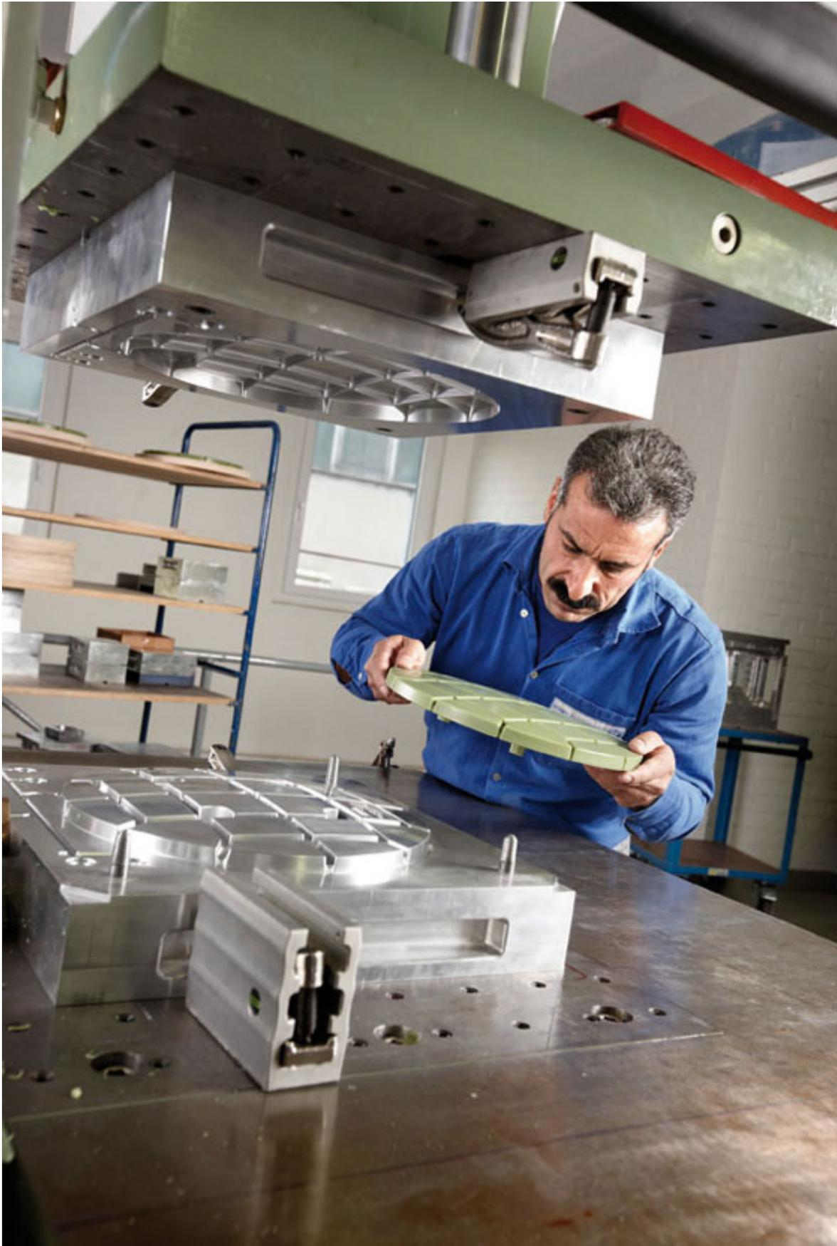
*Der Wachsling wird genau unter die Lupe genommen. In Handarbeit wird er entgratet und die Seriennummer angebracht, Foto von Jan Hosan für pure cast*
