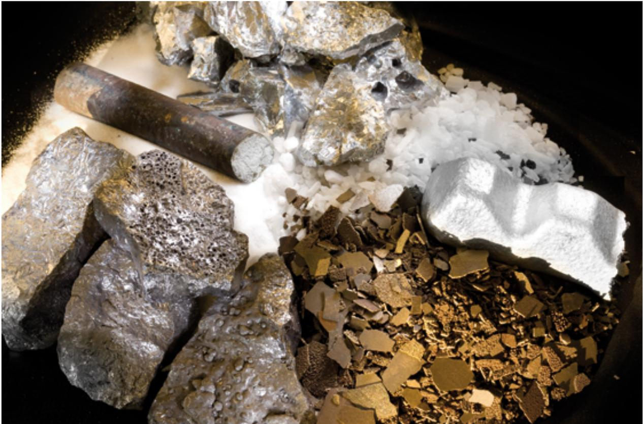
*Die für den Guss von 'Cioccolato' optimale Legierung 19/11 wird exakt nach Rezept zubereitet. Zuschläge wie Chrom, Silizium, Molybden und Eisen werden zugemischt, Foto von Jan Hosan für pure cast*
